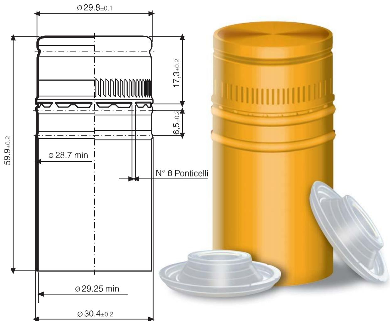
Federfin Tech produce capsule in alluminio per **vini frizzanti**, unendo capacità tecniche e capacità di rispondere ai cambiamenti richiesti dal mercato enologico e dal settore beverage.
