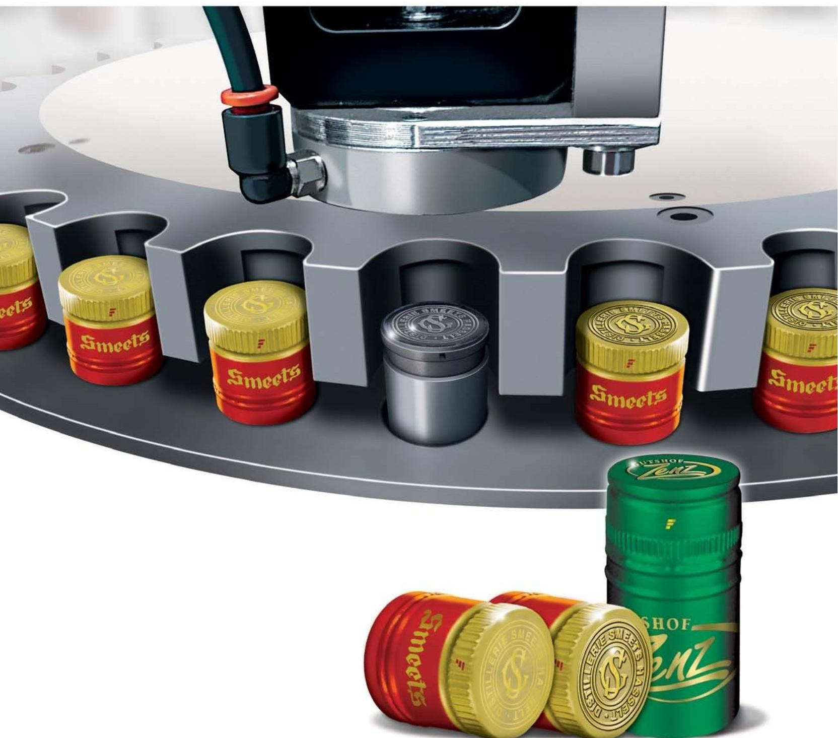
Un ulteriore tipo di personalizzazione consiste nella finitura in **rilievo** della testa della capsula. Le nostre macchine, totalmente innovative, consentono innumerevoli realizzazioni di rilievi a seconda delle esigenze dei clienti con ottima precisione. Il rilievo può contemporaneamente essere rifinito in tampografia o in stampa a caldo a seconda del tipo di finitura opaca o brillante concordata con il cliente.
